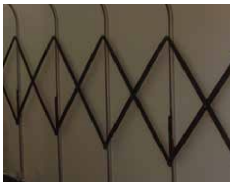
Aluminium-Faltsystem lässt den Tunnel sehr leicht zusammenfallen
